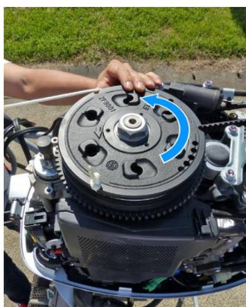
10. ロープを溝にそって反時計方向に3回巻き付けます。
