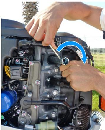
18. 点火プラグを、ネジ山を壊さないように、まず指で軽くまでねじ込みます。手でいっぱい締めこんでから、工具で1/8—1/4回転締めつけます。
