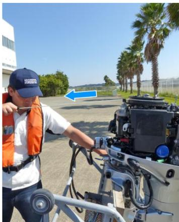
15. ACGカバーをとりはずし、付属部品の始動ロープで数回引っ張り、エンジンから水を排出します。
