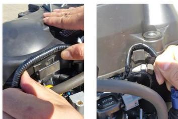
4. ACGカバーのクランプからハーネスを外します。外したハーネスはエンジン側に固定します。
