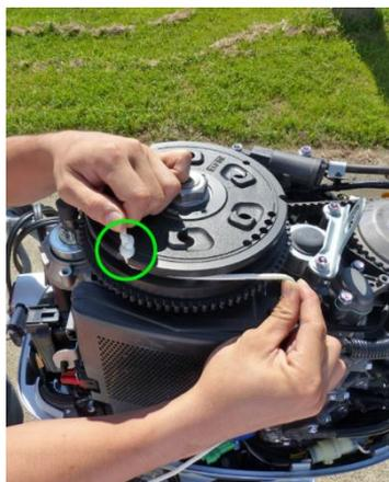
9. 付属部品の始動ロープの結び目をACGローターの切り欠きに引っかけます。
