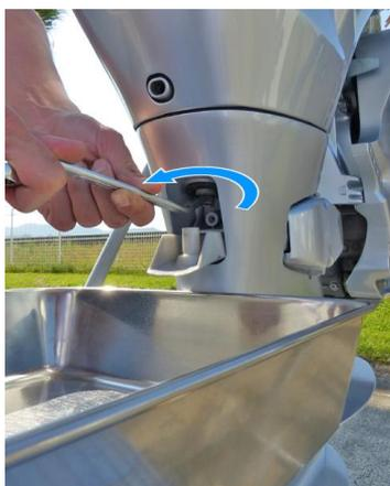
10. ドレンボルトカバーの下にドレンパン（排油受け）を置きます。ドレンボルトカバーとドレンボルトを、工具を使って取り外します。エンジンオイルがしずくになるまでしっかりと排出してください。
