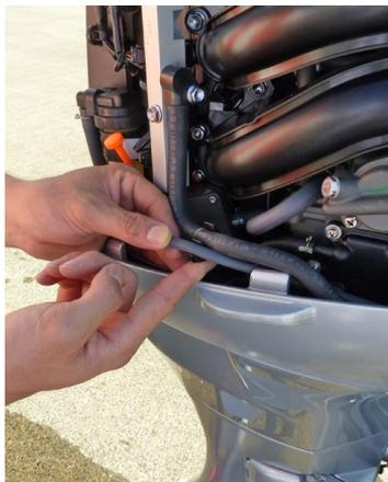
3. インテークマニホールドの突起部に固定されているドレンチューブを外し、チューブの端をアンダーカバーの外に出します。
