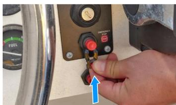
11. 非常停止スイッチに非常停止スイッチクリップを取付けます。カールコードを運転者に装着してください。
