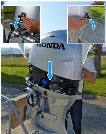
14. エンジンが始動したらACGカバーは取付けずに、エンジンカバーを取付け、確実にロックします。
