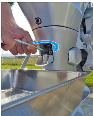
11. エンジンオイルを排出したら、ドレンボルトを新品のシーリングワッシャーとともに取り付けてください。工具でしっかりと締めつけます。ドレンボルトカバーを取り付けます。
