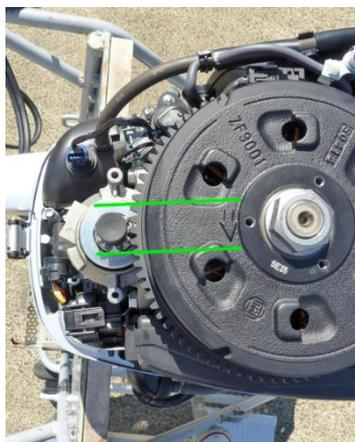
7. ACGローターを反時計回りに回し、矢印マークをスターターモーターの位置に合せます。画像の位置を参考にしてください。
